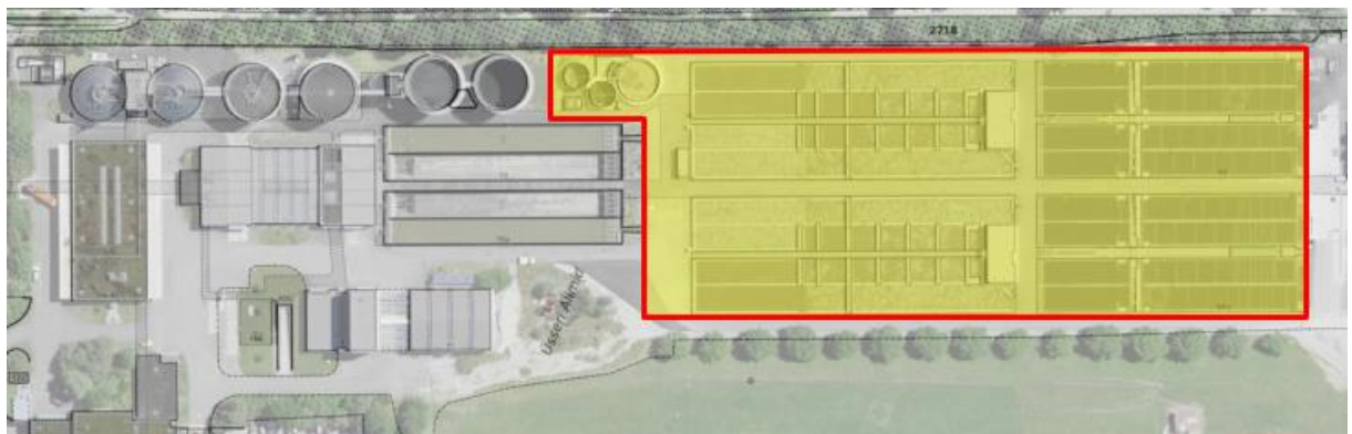
Abbildung 1: Biologische Stufe auf der ARA Thunersee (die Annamox-Behälter sind nicht Teil des Projekts)
